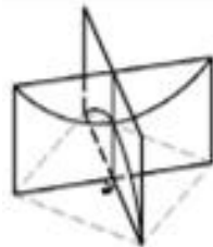
LOS DOS PARABOLOIDES DE IGUAL CURVATURA Y CONTENIDOS EN PLANOS VERTICALES FORMANDO ENTRE SI UN ANGULO RECTO
