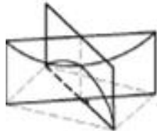
UN DE LOS PARABOLOIDES DE IGUAL CURVATURA Y CONTENIDOS EN PLANOS VERTICALES FORMANDO ENTRE SI UN ANGULO OBLICUO
