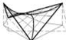
UN PARABOLOIDE Y UN CONTENIDO EN UN PLANO VERTICAL, Y EL PARABOLOIDE Y UN CONTENIDO EN UN PLANO OBLICUO
